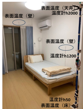
写真4 201号室の温度計測
