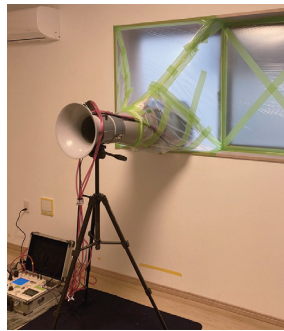
写真3 住戸単位での気密測定
