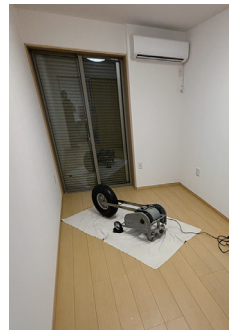
写真5 重量衝撃音試験/加振室
